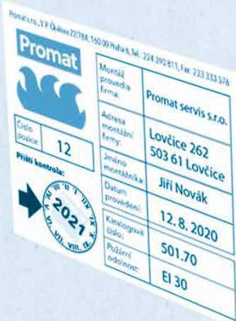
**Požární těsnění prostupů instalací
