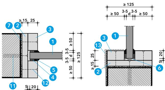
Detail B - vestavba do masivní stěny
