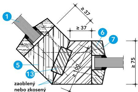
Detail E - rohové spojení > 90° až < 180° (≤ EI 45)
