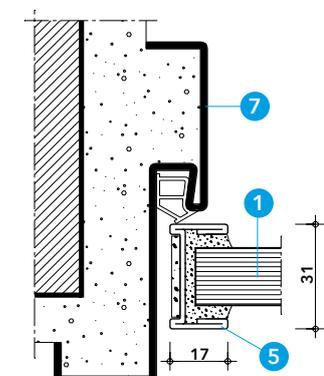
Detail B - rohová zárubeň s dorazem dveří
