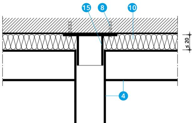
Detail D - posuvné připojení k masivnímu stropu
