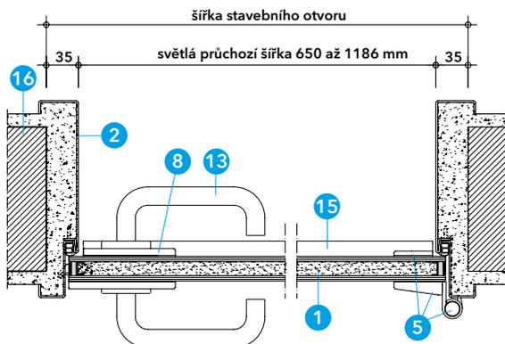
Detail B - vodorovný řez A-A - jednokřídlé dveře
