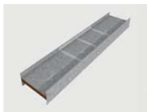
Detail Y - provedení izolace z desek z minerální vlny
