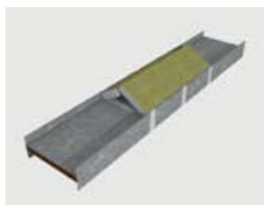
Detail Y - provedení izolace z desek z minerální vlny
